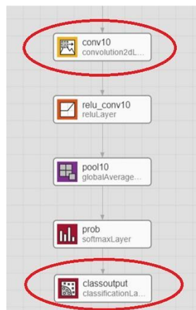
Рис. 3. Корректируемые слои CNN SqueezeNet
