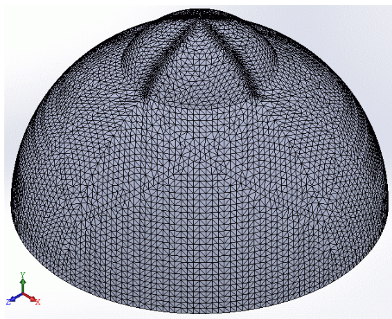
Рис. 4. Конечно-элементная модель роговицы с дефектом
